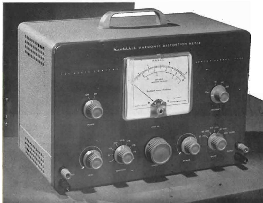
Fig. 1 | Foto del distorsionometro HD1 della Heath.
